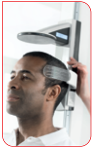
La pantalla en la corredera de medición indica la talla comprobada.
