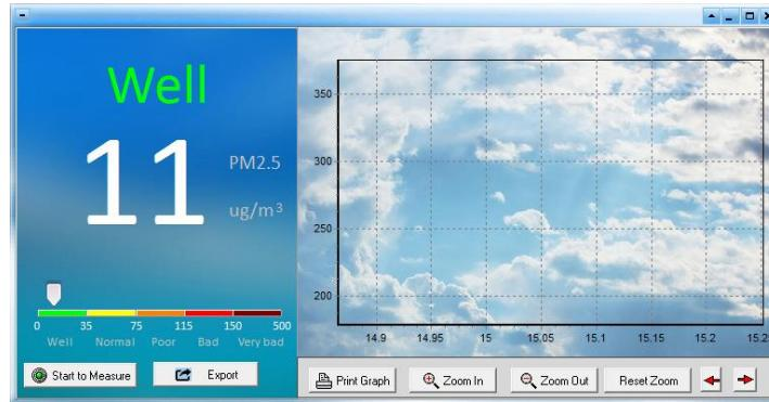
Este software está diseñado para que pueda hacer mediciones en tiempo Real así como imprimir los gráficos y exportar los datos.
